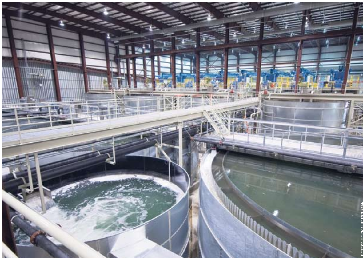
Het ontwateringsgedeelte van de baggerverwerkingsinstallatie, met op de voorgrond de indiktanks en helemaal achterin de blauwe membraanfilterpersen.
